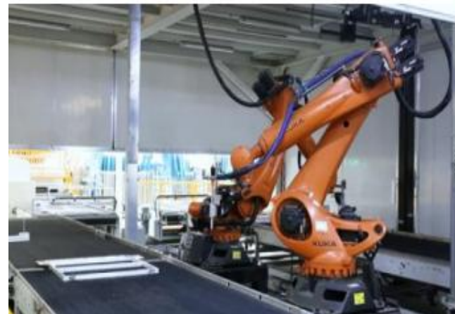
车门框视觉定位涂胶
